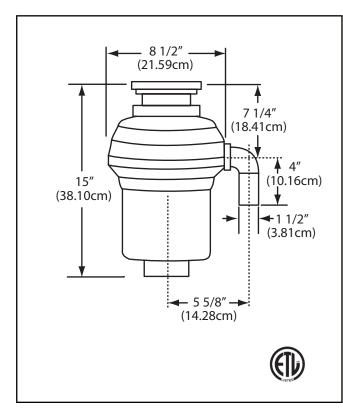
MOTOR HORSEPOWER 1/2 HP
